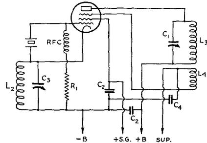
FIG. 810-B — REGENERATIVE TRI-TET CIRCUIT FOR INCREASING FOURTH-HARMONIC OUTPUT
