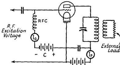
**FIG. 811 — A SIMPLIFIED AMPLIFIER CIRCUIT**
