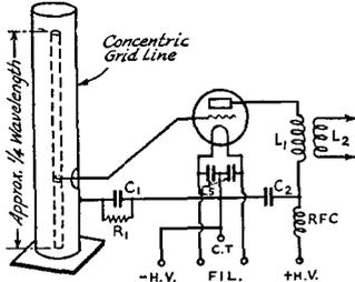
FIG. 1414—A TYPICAL SINGLE-TUBE TRANSMITTER WITH A CONCENTRIC GRID LINE
