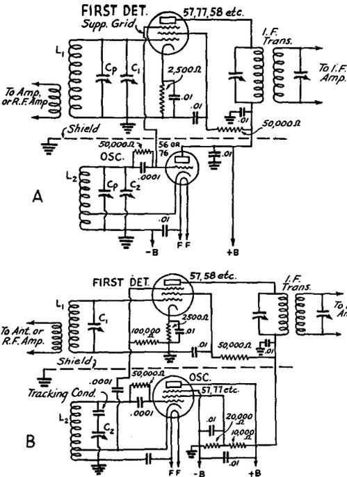
FIG. 614 - CONVERTER CIRCUITS EMPLOYING SUPPRESSOR-GRID INJECTION
