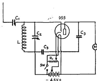
FIG. 1719 — CIRCUIT OF THE SIMPLE FIELD-STRENGTH METER
