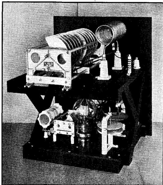
FIG. 947 — A REAR VIEW OF THE HIGH-POWER PUSH-PULL AMPLIFIER
