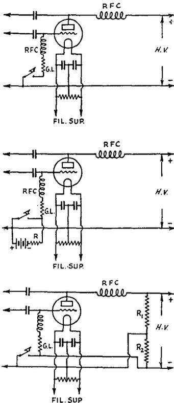
FIG. 1002 — THREE METHODS OF BLOCKED-GRID KEYING
