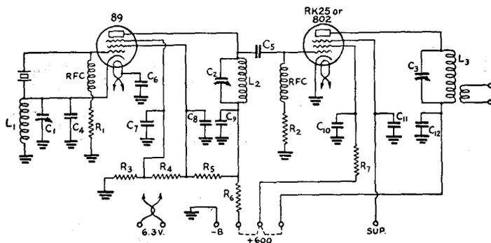
**FIG. 917 — CIRCUIT DIAGRAM OF THE TWO-STAGE EXCITER UNIT**
