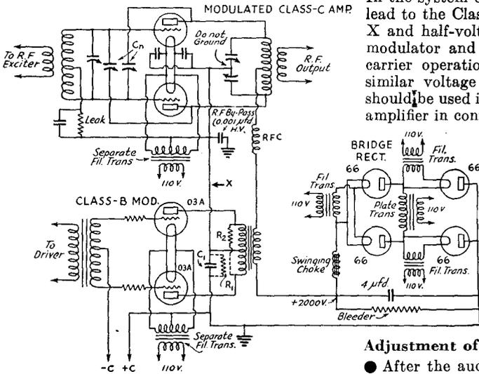
FIG. 1215 — CONTROLLED-CARRIER CIRCUIT FOR 1000-VOLT TUBES (W2HLM)
