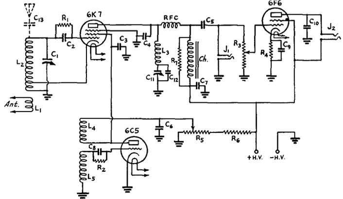
FIG. 1310 — CIRCUIT OF THE SEPARATELY-QUENCHED RECEIVER
