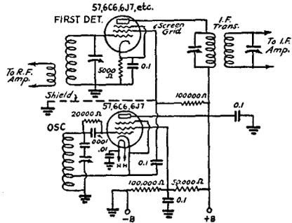
FIG. 615 - CONVERTER CIRCUIT FOR SCREEN-GRID INJECTION
