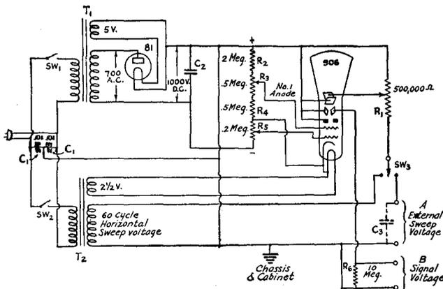
FIG. 1722 — SIMPLE OSCILLOSCOPE CIRCUIT FOR CHECKING AMATEUR TRANSMITTERS
