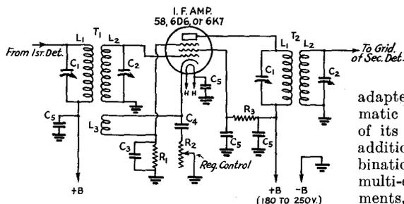
FIG. 625 — HIGH-SELECTIVITY REGENERATIVE I.F. AMPLIFIER CIRCUIT
