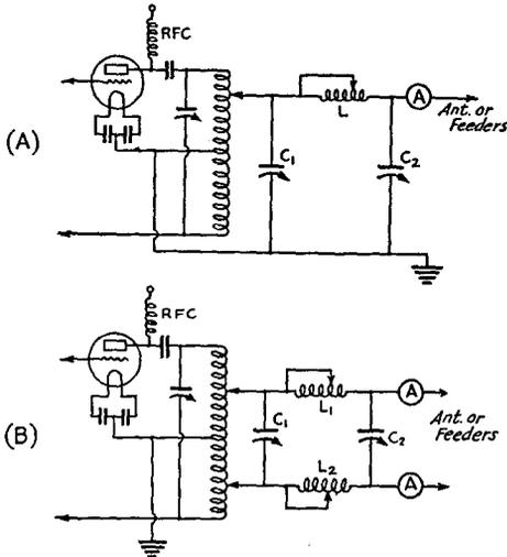
FIG. 1626 — ANTENNA-COUPLING FILTERS
