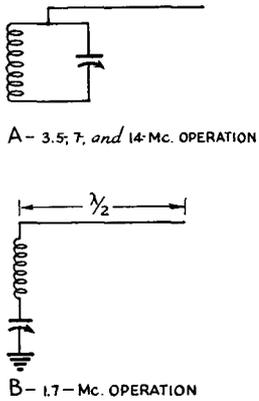
FIG. 915 — ANTENNA TUNER CONNECTIONS FOR VARIOUS BANDS
