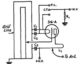
FIG. 1415 — THE CIRCUIT OF THE TROUGH-LINE CONTROLLED TRANSMITTER
