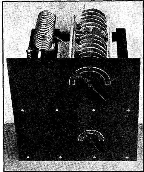
FIG. 946 — A HIGH-POWER HIGH-FREQUENCY PUSH-PULL AMPLIFIER
