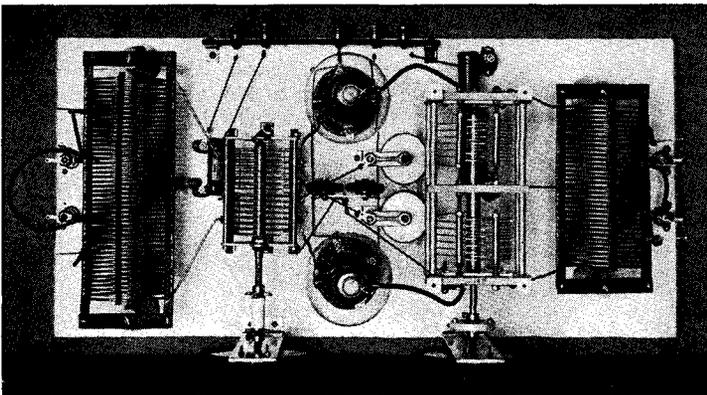
**FIG. 941 — A PUSH-PULL AMPLIFIER FOR HIGH-FREQUENCY**
