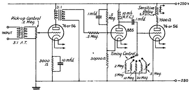
FIG. 1303 — VOICE-CONTROLLED RELAY FOR 'PHONE BREAK-IN WORK
