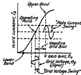
FIG. 502 — OPERATING CHARACTERISTICS OF A VACUUM-TUBE AMPLIFIER
