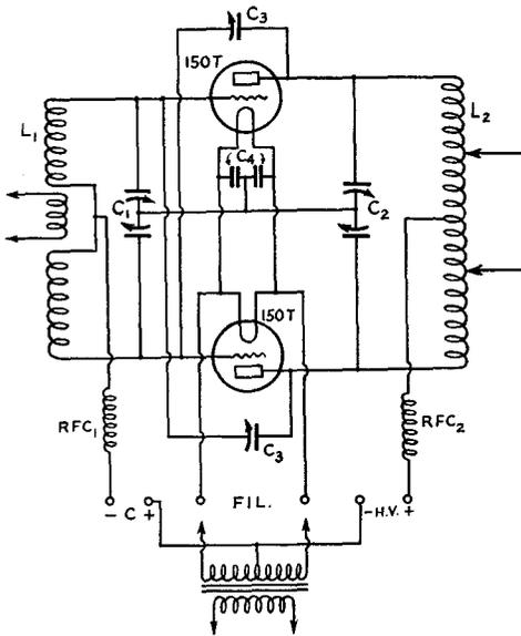
FIG. 945 — CIRCUIT DIAGRAM OF THE HIGH-POWER 150T AMPLIFIER
