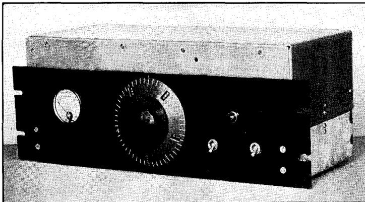
**FIG. 1701 — A COMBINATION HETERODYNE FREQUENCY METER AND MONITOR**
