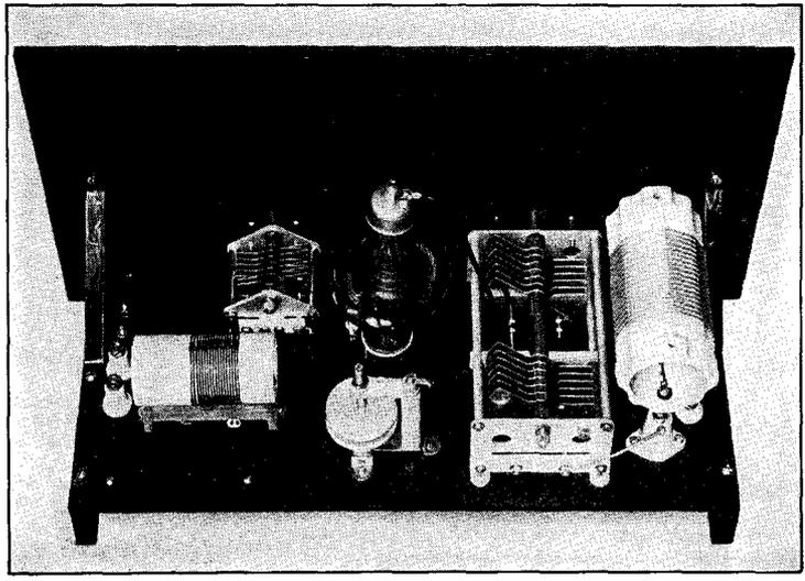
FIG. 937 — A SINGLE-TUBE HIGH-FREQUENCY AMPLIFIER OF MEDIUM POWER
