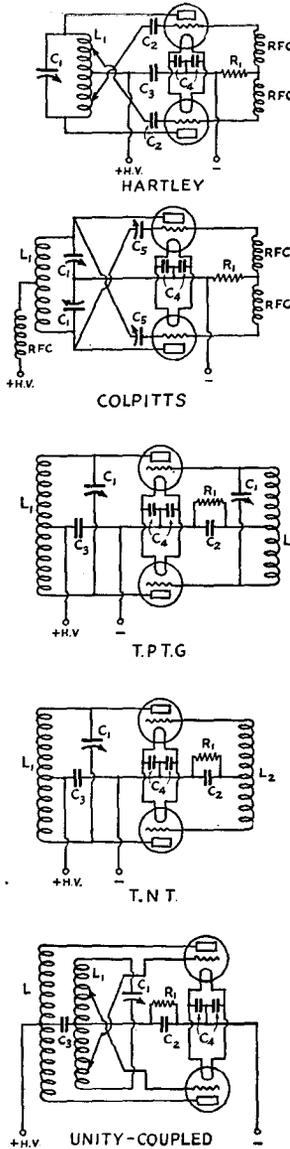
FIG. 303 — PUSH-PULL SELF-CONTROLLED OSCILLATOR CIRCUITS
