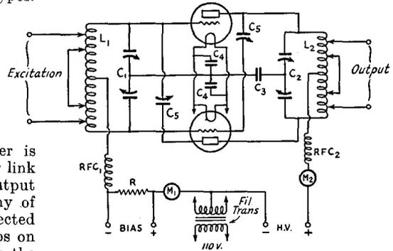
FIG. 942 — CIRCUIT OF THE PUSH-PULL AMPLIFIER
