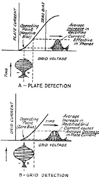
**FIG. 513 — OPERATING CHARACTERISTICS OF PLATE AND GRID DETECTORS**
