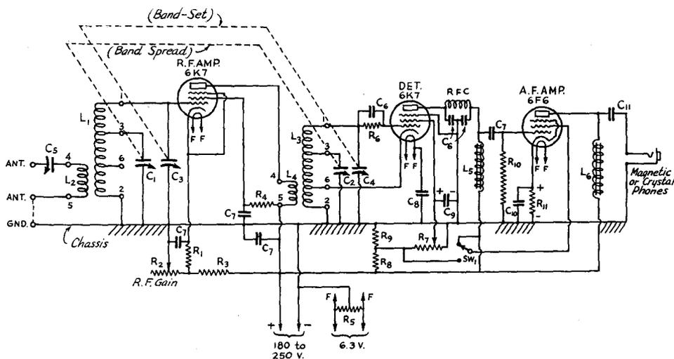
FIG. 716 — CIRCUIT OF THE BALANCED T.R.F. RECEIVER
