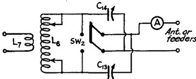
FIG. 932 — WIRING OF THE ANTENNA TUNER
