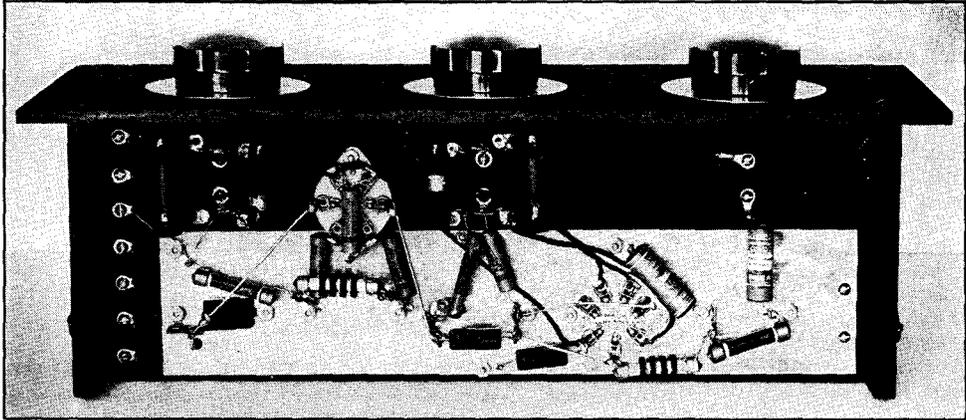
**FIG. 918 — BOTTOM VIEW OF THE TWO-TUBE EXCITER**
