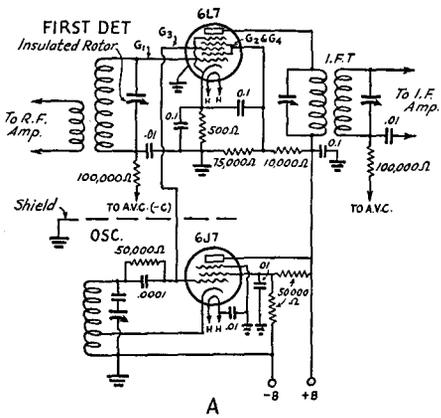
FIG. 616 - CONVERTER CIRCUITS FOR THE 6L7 TUBE
