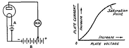
FIG. 501 — THE DIODE OR TWO-ELEMENT TUBE AND A TYPICAL CHARACTERISTIC CURVE
