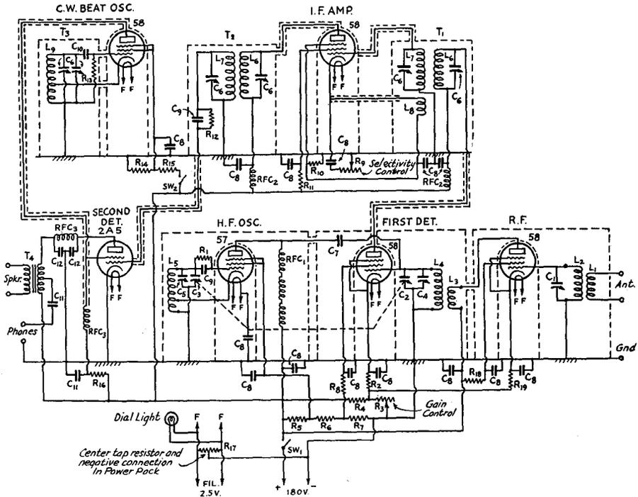
**FIG. 720 — CIRCUIT OF THE SIX-TUBE REGENERATIVE S.S. RECEIVER**
