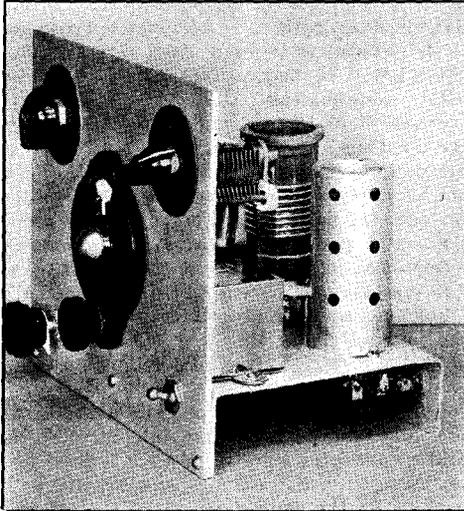
FIG. 702 — PANEL VIEW OF THE TWO-TUBE TRIODE RECEIVER
