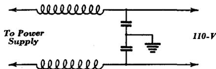
FIG. 1011 — R.F. FILTER FOR THE POWER LINE
