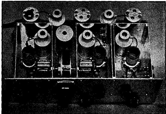
FIG. 718 — A SIX-TUBE REGENERATIVE SINGLE-SIGNAL SUPER-HETERODYNE RECEIVER
