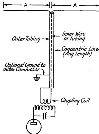
FIG. 1619 — HALF-WAVE ANTENNA WITH CONCENTRIC TRANSMISSION LINE
