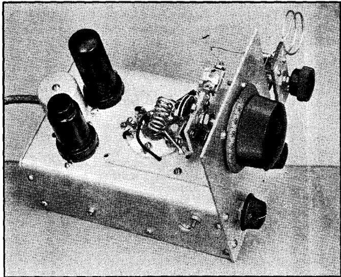
FIG. 1312 — THE ACORN TUBE IN A SEPARATELY-QUENCHED RECEIVER
