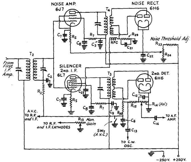
**FIG. 628—SILENCER CIRCUIT APPLIED TO THE SECOND I.F. STAGE OF A TYPICAL SUPERHET. THIS CIRCUIT IS NOT ADAPTABLE TO RECEIVERS IN WHICH A COMMON BIAS CIRCUIT IS USED FOR I.F. AND AUDIO CONTROL GRIDS. THE NEGATIVE-B OF THE HIGH-VOLTAGE SUPPLY MUST BE GROUNDED AT THE FILTER OUTPUT**
