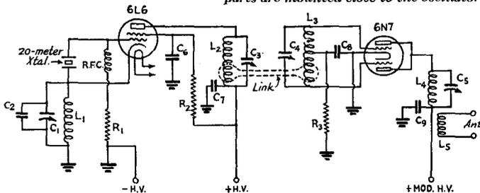
FIG. 1425 — THE CIRCUIT OF THE MOBILE TRANSMITTER
